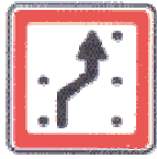
B.5 Obbligo di tenere i gruppi o i pali a destra nei canali segnalati da un lato solo
